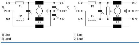
1)  $PE \circ F1 \rightarrow Cx$   $R \circ L^2$  PE'No  $F2 \rightarrow Cx$   $R \circ L^2$  PE'No  $L^2 \rightarrow Cy$  N'1) Line 2) Load
